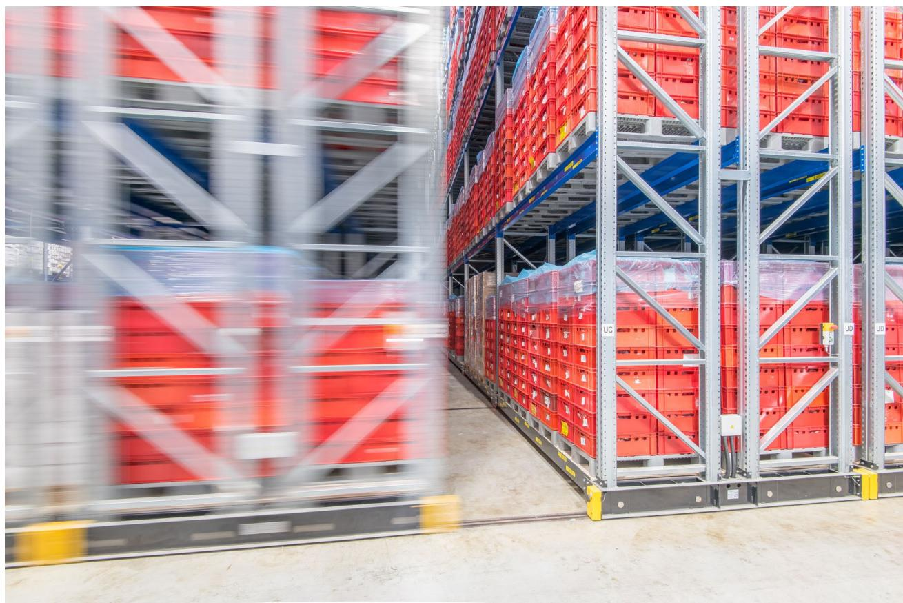
Uno dei principali vantaggi di un sistema che utilizza basi mobili, rispetto a un sistema di palletizzazione convenzionale, è il maggiore sfruttamento dello spazio destinato allo stoccaggio dovuto alla riduzione del numero di corsie..
